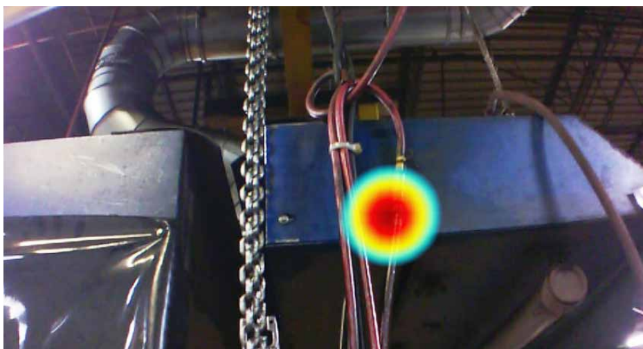
産業環境でのエアリークの ii900 Industrial Acoustic Imager で撮影した画像。
