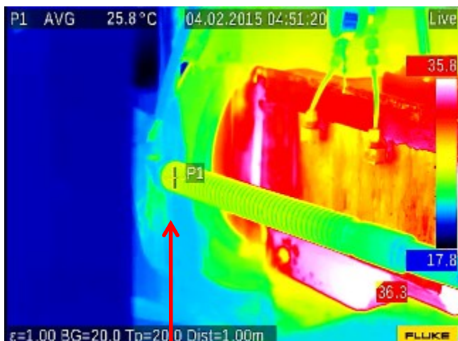
加工現場のビデオ画面、矢印部分が冷却油、P1点がカッティング加工された直後のスクリューロッドの表面温度であり、当該現場の実測表面温度はプロセス要求と一致する。
