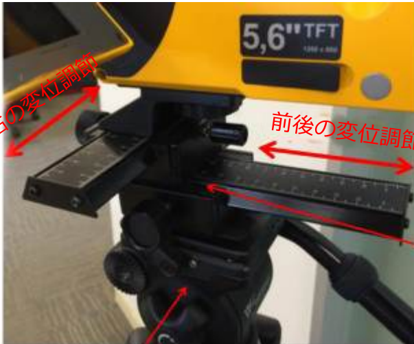
専用の三脚（油圧ダンピング機能付き）
